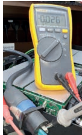
Bild 2: Die Messung des DC-Offset an den Lautsprecherklemmen liegt mit 26 Millivolt im normalen und ungefährlichen Bereich
